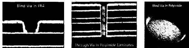
그림 6. 레이저 가공된 blind viahole 및 관통 ViaHole
