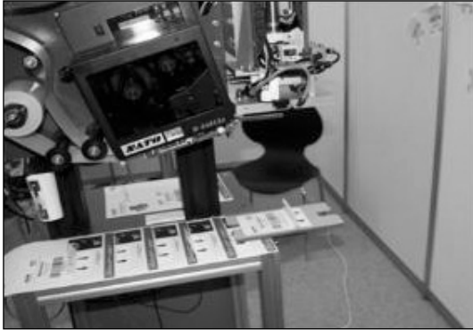
[그림 14] 베이직하우스사의 재활용태그 자동발행기
