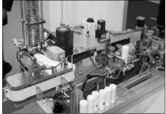
[그림 16] 바이텍테크놀로지가 개발 중인 RFID 자동부착기
