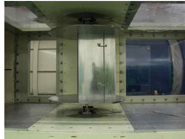
그림 11. Model Installation in KARI LSWT
