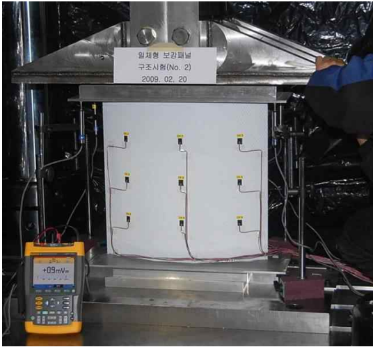
그림 2. 샌드위치 패널 시편의 압축 시험 모습
