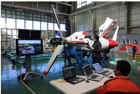
그림 3. 비행체 HILS(Hardware In the Loop Simulation)시험
