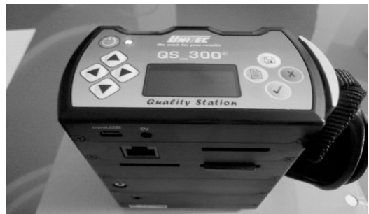
그림 3. 휴대용 비파괴 과일 내부품질 센싱장치
