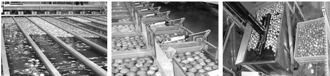
그림 9. APOFRUIT 공장 사과세척시스템 과정
