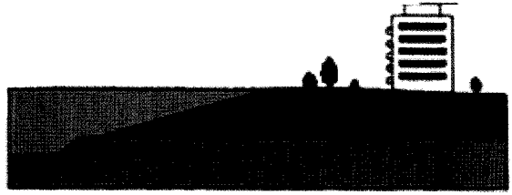
〈그림 9〉 제방의 높이를 넘는 대홍수에서도 물이 제방 위를 완만하게 흐르므로 제방 자체가 망가질 걱정이 없다.
