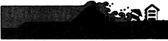
〈그림 8〉 현재의 치수 계획을 넘는 대홍수로 강물이 제방의 높이를 넘을 때, 보통 제방은 망가질 위험성이 있다.
