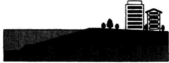
〈그림 11〉 강의 수위 상승이 장기간에 걸쳐 계속되면서 물이 제방에 침투해도 넓은 폭의 제방은 망가질 걱정이 없다.
