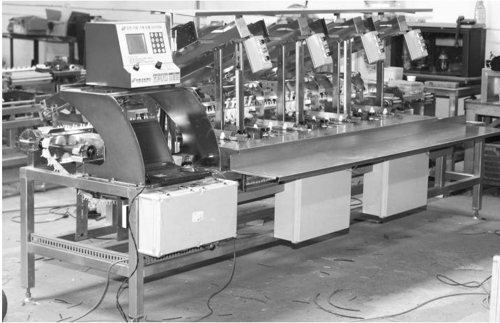
▲ 제작과 테스트 과정을 거치고 있는 유한의 계란선별자동제어시스템
