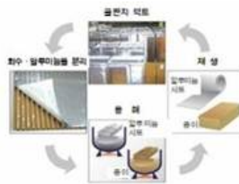
그림 7. 친환경 골판지덕트의 생산 및 폐기(리사이클링) 공정
