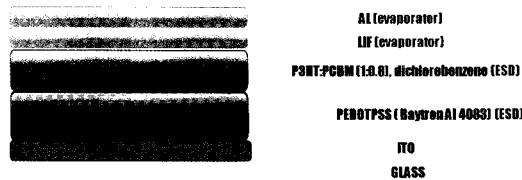
그림 10. ESD 스프레이 공정을 적용한 OPV 셀 구조
