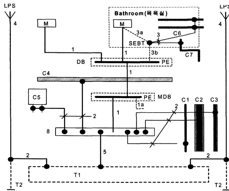
[비고] B : 주접지단자, C : 도전성 부분, C1 : 수도관, C2 : 배수관, C3 : 가스관, C4 : 공조기, C5 : 난방기, C6 : 급수관(목욕탕), C7 : 암즈리츠 내의 금속관, DB : 분전반, LPS : 피뢰시스템, M : 노출도전성 부분, MDB : 주 분전반, SEBT : 보조등전위 본딩, T : 접지극, T1 : 기초접지극, T2 : 피뢰용접지극(필요시)
