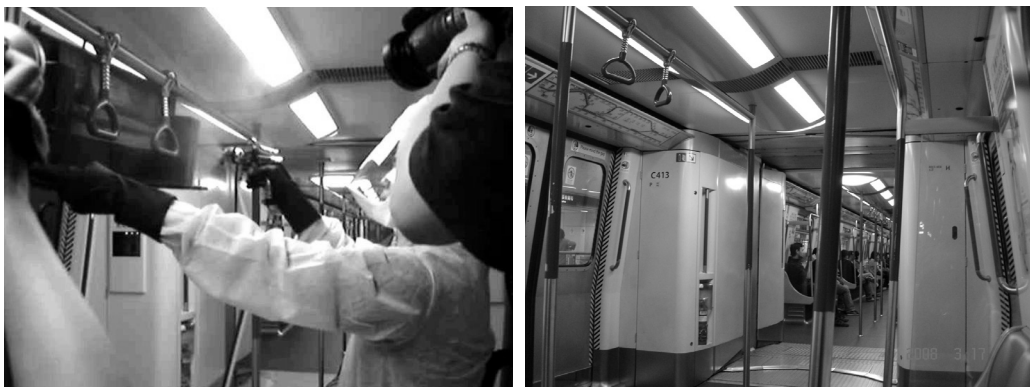
그림 15. 홍콩지하철 객실 내 손잡이 등의 코팅작업 및 완료 모습
