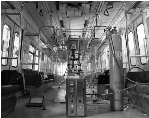
그림 11. 시험차량을 이용한 공기청정 모듈 평가시험
