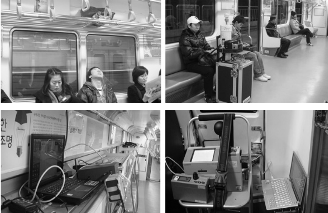
그림 2. 지하철 객실 공기질측정 장비 설치 모습
