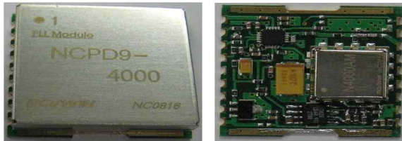
그림 13. PLL 실제 사진
