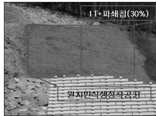
사진 2. 얇은 식생기반재 실험구 전경(시공두께 3cm).
