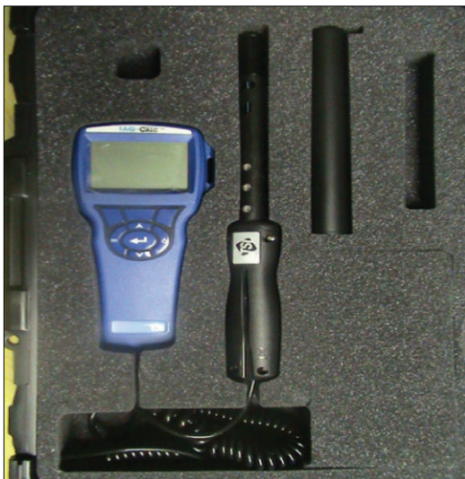
그림 1. 이산화탄소 측정 장비(TSI-7535)
