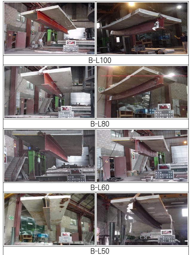
그림 5. 보부재 내화시험체의 시험전후 모습
