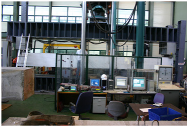
그림 6. SSC 휨실험체의 설치모습
