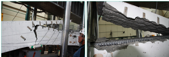
그림 17. USC 휨실험체 항복 후 모습
