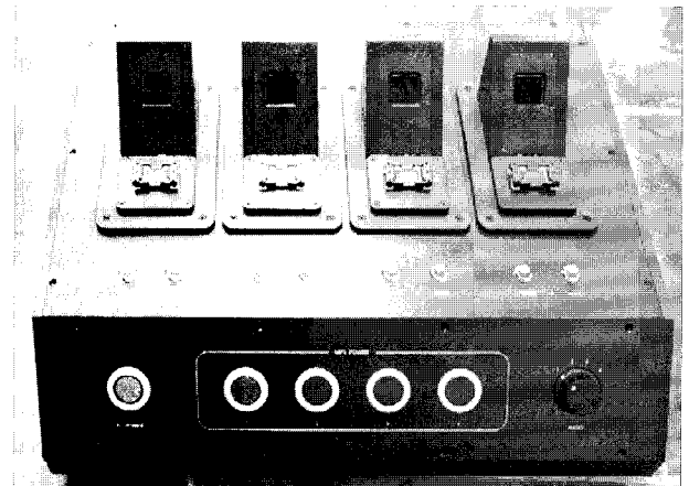
그림 7. 제작된 MP3 장치 실장기 Fig. 7. The implemented MP3 device application-level tester.
