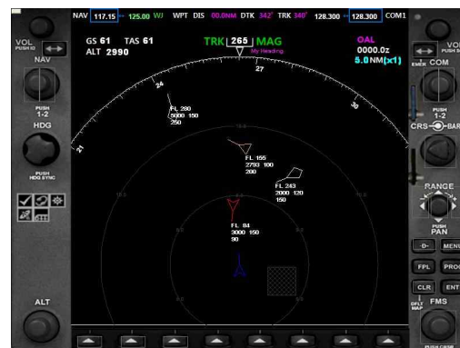
Fig. 16 ADS-B Data 표시된 ND 화면 구성
