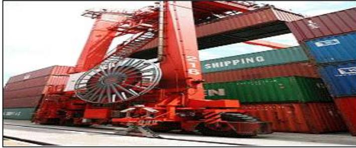
이에 따라 부산항의 신감만, 자성대, 신선대, 감만 등의 컨테이너터미널에서는 야드에 설치된 크레인의 에너지 공급체계를 유류에서 전기로 전환하는 방안을 추진 중이다. 자성대 컨테이너터미널은 2008년부터 RTGC(Rubber Tyred Gantry Crane) 34대 중 15대에 대해서 전기식으로 전환하며, 신감만 컨테이너터미널은 17대 중 12대, 우암터미널은 13대 중 8대를 전환할 예정이다. 부산항만공사는 2007년 8월, 자성대 컨테이너터미널에 RTGC 2대에 대한 전기식으로 동력전환 후, 에너지 절감 정도를 측정하였다. 비용은 유류비의 10% 선에 그친 것으로 밝혀졌다. 부산항만공사는 케이블 설치작업 등을 위해 대당 약 3억 6천만원의 비용이 소요되지만 대당 연간 약 1억 3천만원의 에너지 절감 효과를 거둘 수 있으므로 3년 후면 투자비를 회수할 것으로 예상하고 있다.<sup>15)</sup>
