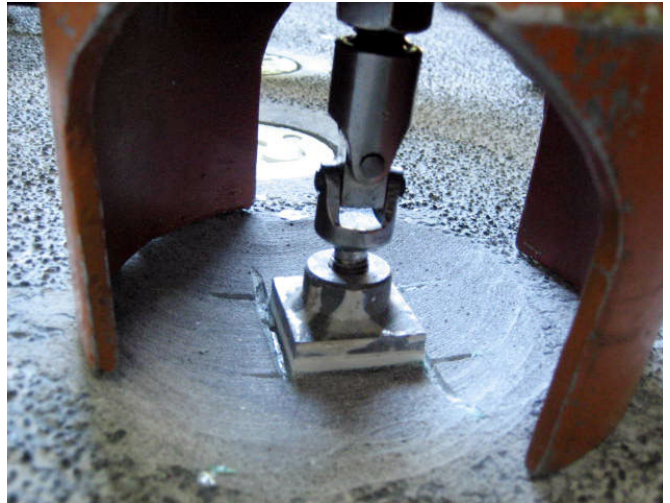
그림 3. 포장가속시험 종료 후 부착강도 측정시험
