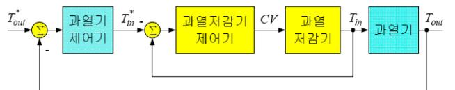
그림 1 과열기의 온도 제어 시스템
