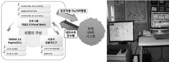
(그림 3) FFC6 프로그램과 MMI System의 연계 운영 및 현장설치
