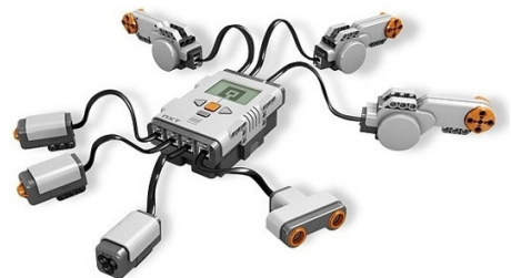
(그림 2) NXT 브릭과 연결된 7개의 센서
