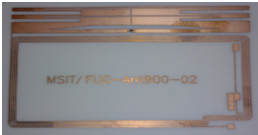
그림 9 최적의 성능을 나타낸 RFID 태그 안테나 Fig. 9 The RFID tag antenna with optimal performance
