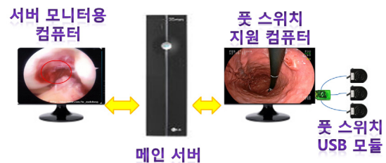
그림 1. 풋 스위치가 연결된 PACS 블록도 Fig 1. Block diagram of PACS with F.S
