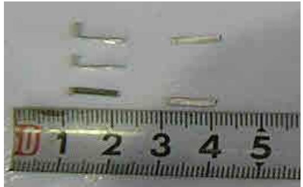
그림 7. 시험에 사용된 금속 결함(원통형 알루미늄 재질) Fig. 7. Metal defects for experiment (cylinder type, AL)
