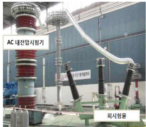
그림 5. 상용주파 내전압 시험설비 Fig. 5. Test Set-up for AC withstanding voltage
