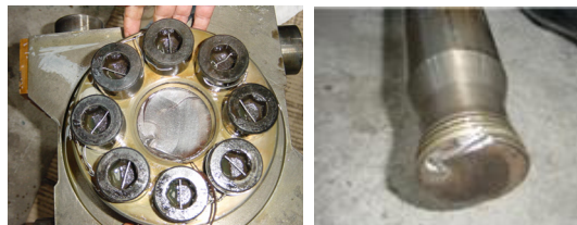
사진 17: 피치제어 기구의 Push-pull rod 절손 사례(2)
