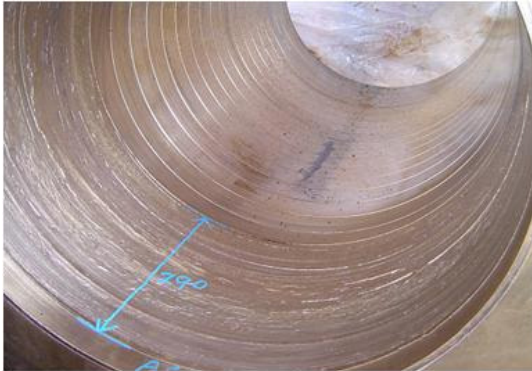
그림 10: 프로펠러 Slip 손상(보스 내면)
