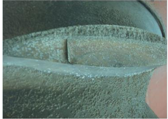
그림 3: 블레이드 절손 탈락 파단면 상태
