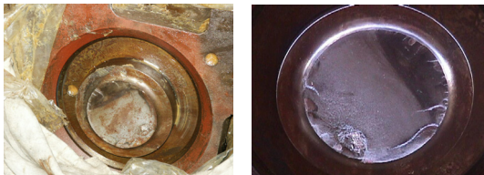
사진 16: 피치제어 기구의 Push-pull rod 절손 사례(1)
