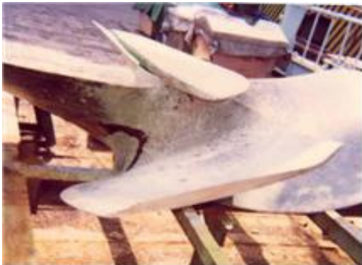
그림 19: 용접 수리부의 절손 탈락
