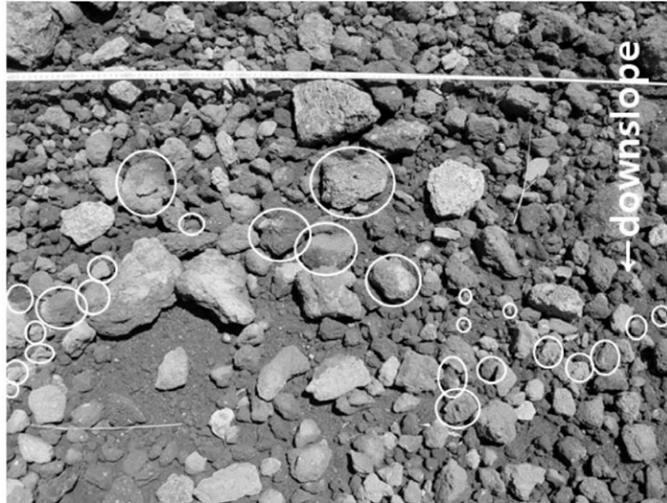
Figure 10. The movement of gravels gets faster with an increase of gravel size. The measuring tape indicates the original position of Line I . 크기가 작아질수록 자갈의 이동량은 커진다. 줄자가 놓여 있는 곳이 측선 I 이 처음 설치된 위치이다.
