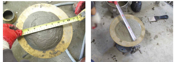
그림 4. 경량기포모르타르 타격 플로우값 측정 광경
