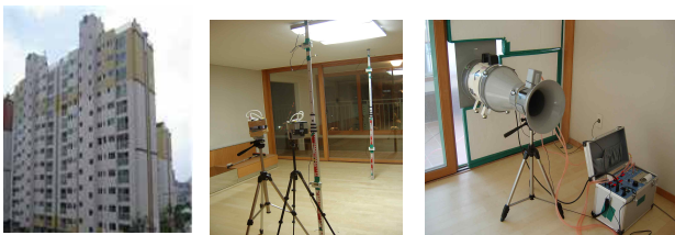
a) A 공동주택 외관 b) 미니 펌프 설치 c) 기밀 성능 측정
