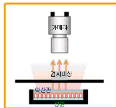
<그림 7> 원거리 조명의 내부구조 및 원리
