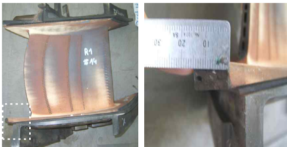
<그림 25> 1단 고정날개 탈락부 상태
