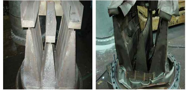
<그림 16> 정상 상태와 손상된 Filter 상태
