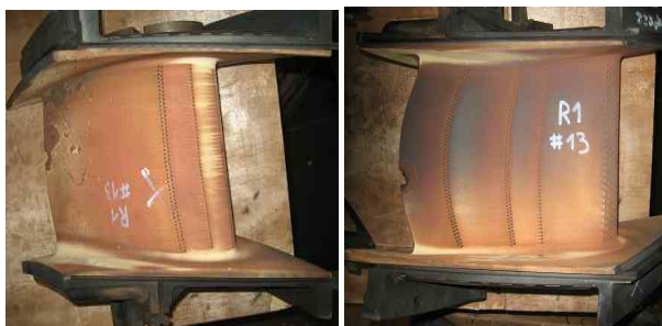
1단 Vane Suction Side 충격 손상 흔적 있음
