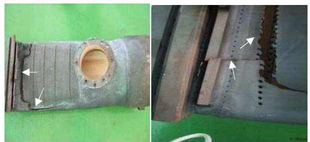
<그림 10> 연소기 균열 손상 상태
