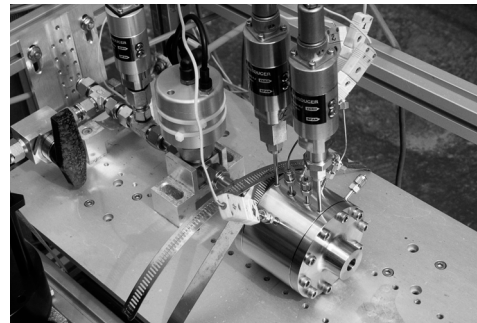
Fig. 4 EM thruster on thrust stand
