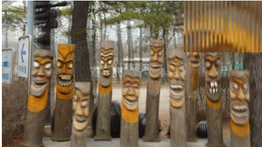
Column Interleave 방식. 좌우 영상을 세로로 한줄씩 넣어서 배치하는 방식. 우측상단은 해당부분을 4배로 확대한 화면
