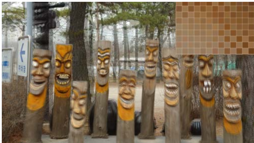
Checkerboard 방식 한점씩 좌우 영상을 교대로 배열하는 방식. 첫 번째 라인의 좌우로 배열되었으면 두 번째 줄은 우좌 형식으로 배열. 좌측상단은 해당부분을 8배 확대한 화면
