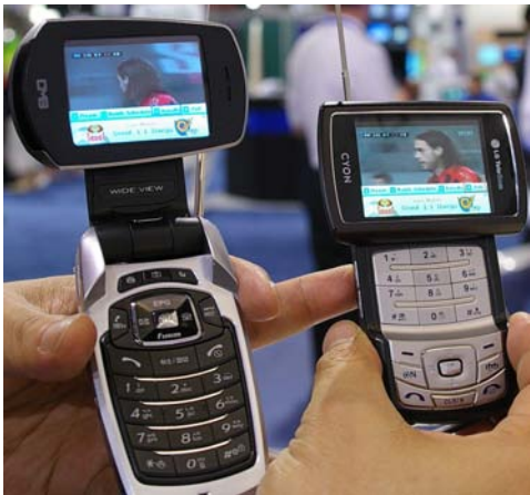
그림 2. 지상파 DMB 휴대폰의 BIFS 콘텐츠 구동 예 Fig. 2. Example of BIFS contents display on T-DMB Phone
