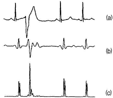
그림 4. QRS 검출 신호처리 예 (a) 신호처리 전의 심전도 (b) bandpass filter 출력 신호 (c) bandpass filter 출력을 differentiation과 squaring 처리 결과 Fig. 4. QRS detection (a) original ECG (b) signal applied bandpass filter (c) differentiation & squaring signal applied bandpass filter.
