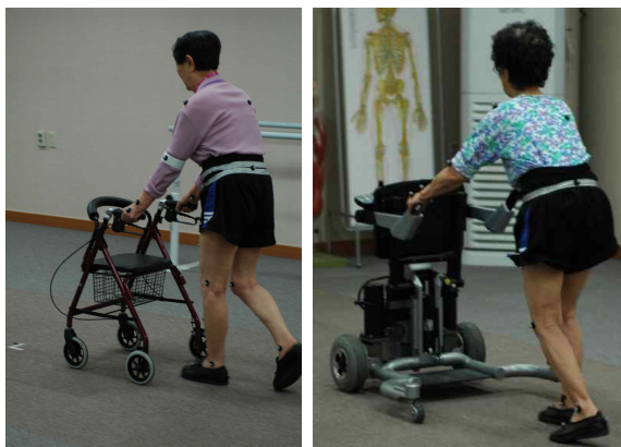
그림 2. 수동 위커와 보행보조로봇을 이용한 노인보행. Fig. 2. Gait with manual walker and robot.
