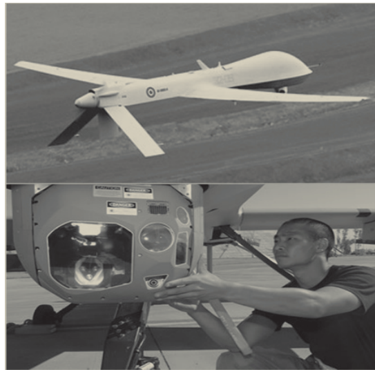
그림 5. 미 공군의 프레데터 무인항공기(위) 및 3차원 영상 레이저 레이더(아래)
