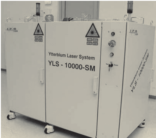
그림 5. a) IPG에서 출시한 10KW급 광섬유 레이저 시스템 사진
