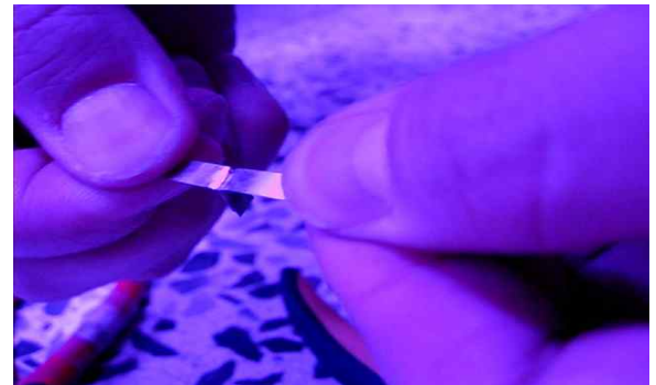
그림 13 두께 0.2mm 인 니켈의 용접결과 Fig. 13 Welding result of 0.2mm thick nickel
