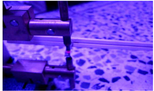
그림 12 두께 0.2mm 인 니켈의 용접과정 Fig. 12 Welding of 0.2mm thick nickel
