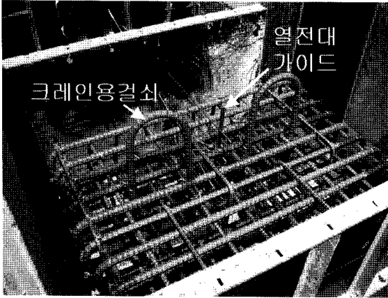
그림 5. 철근 콘크리트 시험체의 철근배근과 열전대 설치
