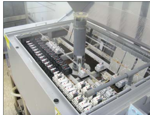
그림 1 염수분무시험장치 Fig. 1 Salt water spray testing chamber
