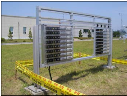
그림 3 내후성 시험 설비(KS D 0060) Fig. 3 Weathering test equipment(KS D 0060)
