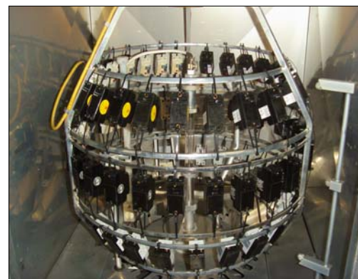
그림 2 ASTM G155에 의한 시험장치 Fig. 2 Acceleration testing chamber by ASTM G155
