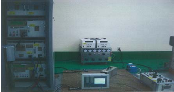
그림 7 1MHz, EFT 버스트 및 서지 내성시험사진 Fig. 7 The picture for the 1MHz burst, electrical fast transient burst and surge immunity test
