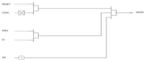
그림 6 차단기(4144)의 트립을 위한 로직도 Fig. 6 The logic diagram for CB(4144) trip
