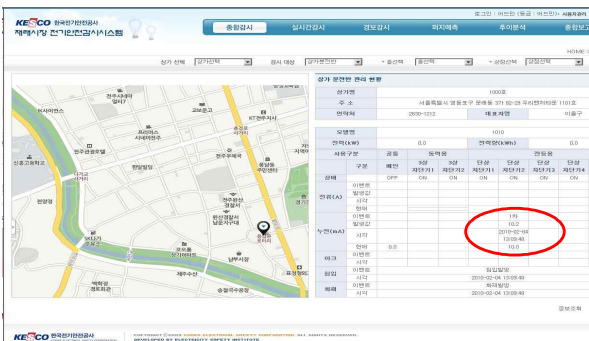
그림 6 상가 분전반 분기 회로의 경고 표시 Fig. 6 Web warning display of cabinet panel branch
