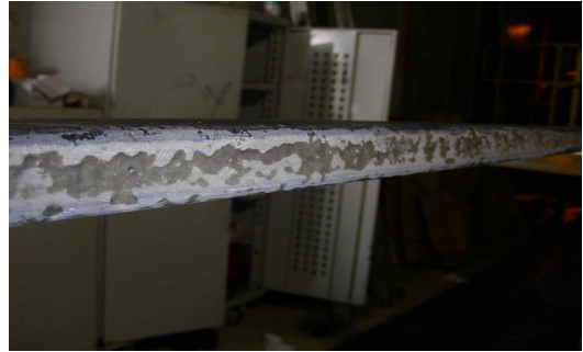
그림 8 반도체층 마멸 Fig. 8 Abrasion of semiconducting layer
