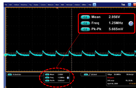
그림 10 Buck-Mode일때 출력전압 측정 파형 Fig. 10 Measured output voltage operating in the Boost-Mode
