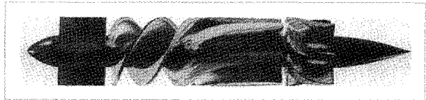
그림 4 CFD 해석을 이용한 디퓨저의 표면 주위로 혈류패턴을 측정하는 것은 전단력의 높은 지점과 낮은 지점의 영역을 표시하여 준다. 파란 영역은 낮은 응력범위를 나타내고, 붉은 영역은 혈액의 흐름에서 난류를 나타낸다. 가장 높은 전단응력은 적은 적혈구 손상을 의미한다.
