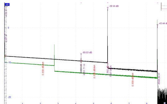
그림 11. 광스위치를 이용한 2차 침입 감시
