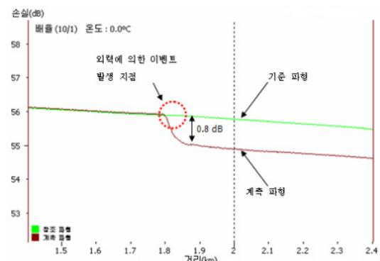
그림 10. 외력에 의한 이벤트 발생 지점 측정화면
