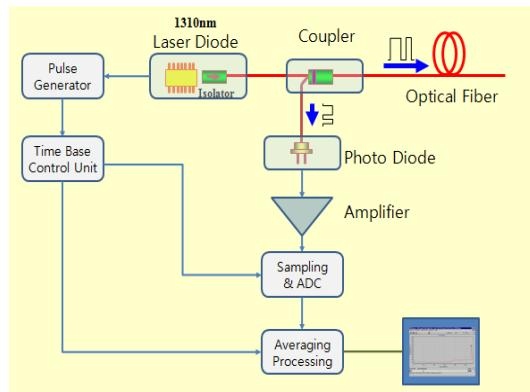
그림 3. 광섬유 센서용 OTDR 구조
