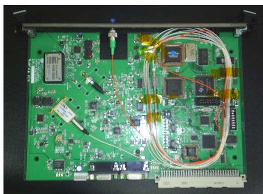
그림 5. 제작된 스위치 내장형 OTDR
