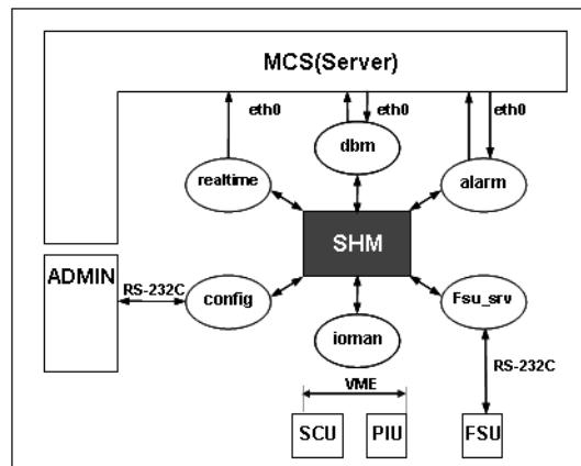
그림 7. 시스템 프로그램 구조도
