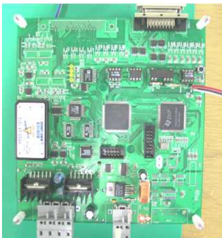
그림 5. 실제 제작된 VCM 디지털 구동 장치 Fig. 5. Digital controller picture
